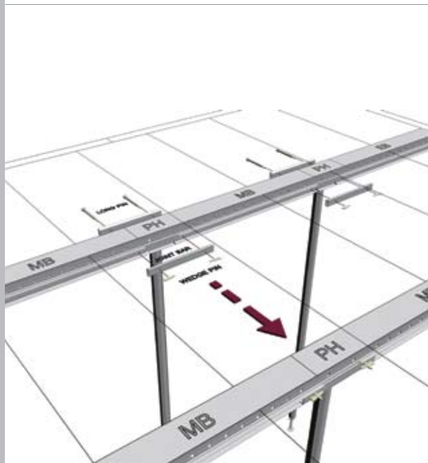
1 Desmonte os pinos longos e barras de junção
